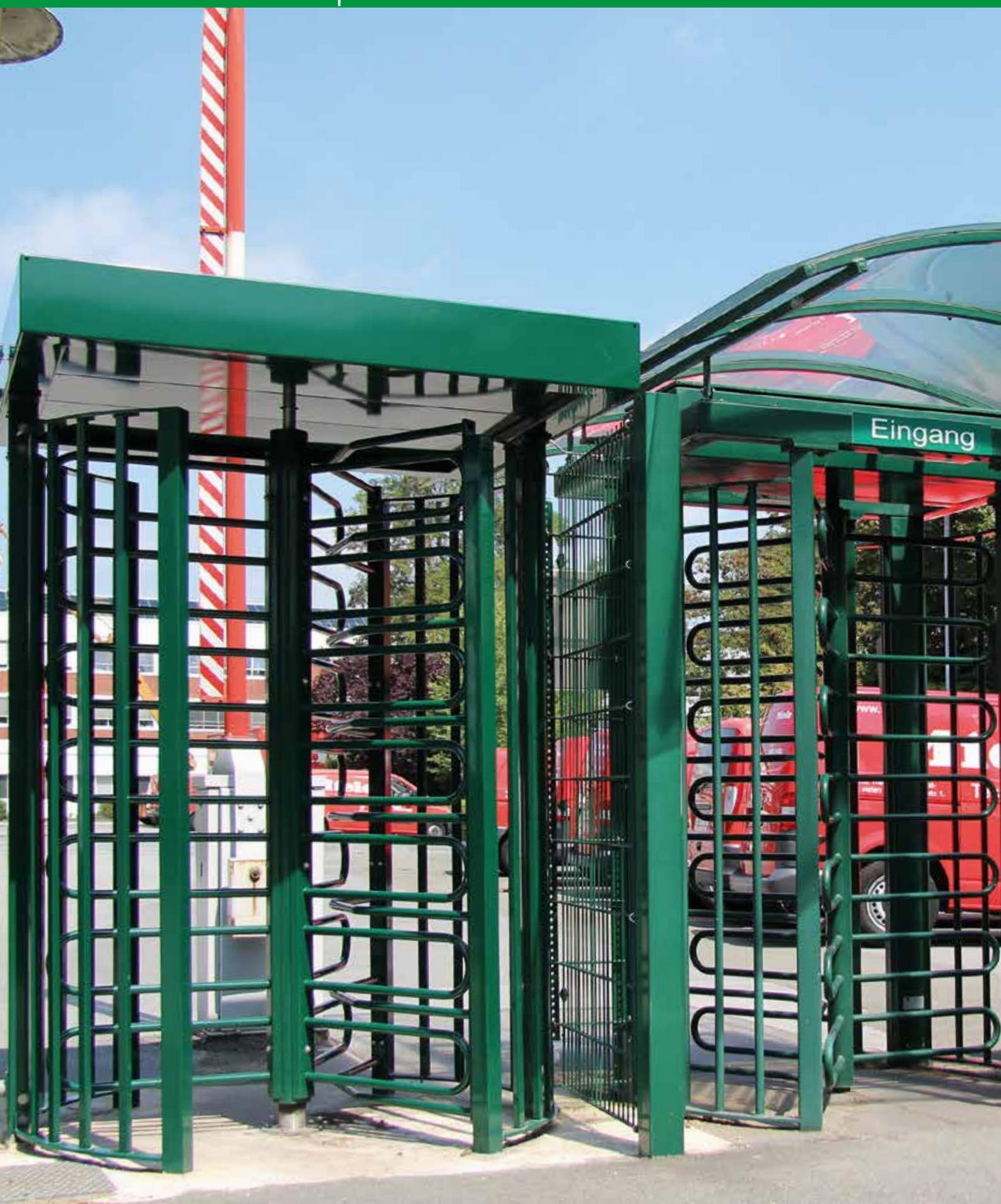
Elektrische Mehrfach-Drehkreuzanlage, grün pulverbeschichtet
