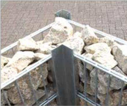
Mit dem Eckprofil bieten wir Ihnen eine elegante Lösung zur Herstellung von 90°-Ecken in Ihrer Gabionenwand. Das Profilpaar besteht jeweils aus Inneneck- und Außeneck-Profil und kann für alle Gabionentiefen eingesetzt werden.
