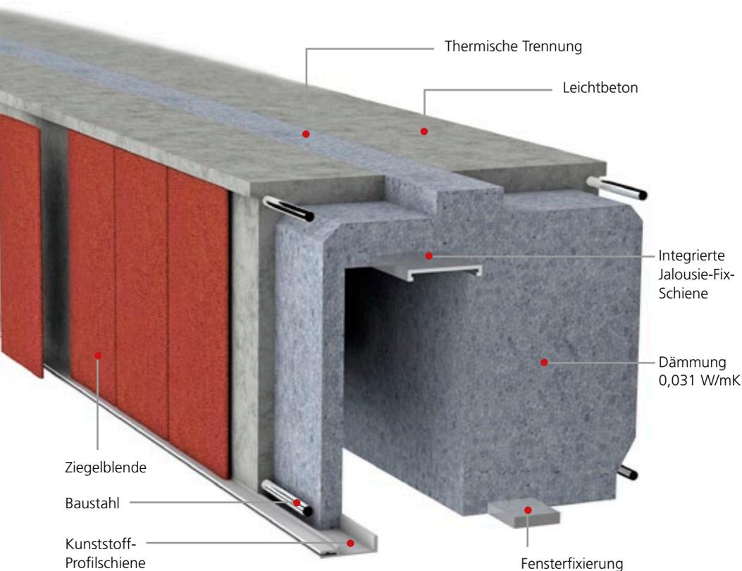
Jalousiekästen für jedes Mauerwerk in vielen Varianten. Diese verschiedenen innovativen Konstruktionen weisen herausragende Schall- und Wämedämmwerte auf (auch im Auflagebereich) und gewährleisten durch die Kombination Leichtbeton und Neoporformteil zudem einen sehr guten Brandschutz.
