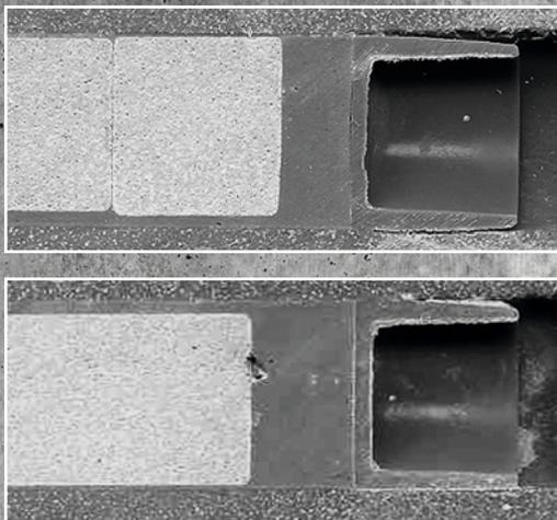
Um ein Durchrutschen des einzuklebenden Stöpsels zu verhindern, ist es erforderlich, einen festen Widerstand zu erzeugen. Hierzu wird mit einer Stahlrohrschlaglehre ein etwas übermäßiger Kunststoff-Stopfen in den Spreizenhohlraum eingetrieben. Der Anschlag an der Lehre sorgt für die richtige Eindringtiefe.
