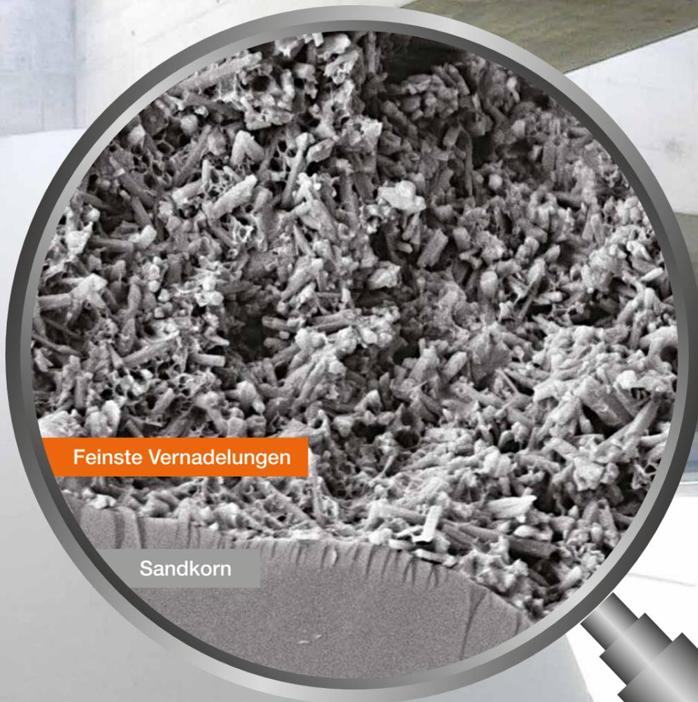
Bei der PCI Nanocret®-Familie wurde die Zementhydratation optimiert. So entsteht auf Nanoebene eine noch bessere Vernadelung, die den Schwund reduziert und die Anhaftung verbessert.
