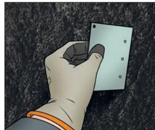
Für die Kontrolle der Nassschichtdicke müssen je Ausführungsobjekt mindestens 20 Messungen bzw. 20 Messungen pro 100 m<sup>2</sup> durchgeführt werden. Dazu wird ein Schichtdickenmesser verwendet.
