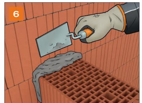
6 Beim Stumpfstoß Anschlussfuge satt vermörteln.
