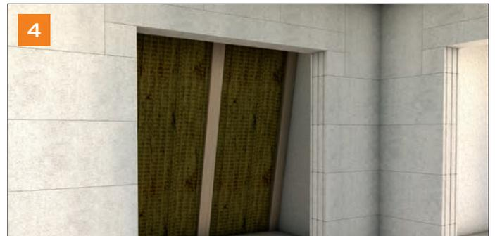
Flachsturz mit vermörtelten Stoßfugen in der Übermauerung.
