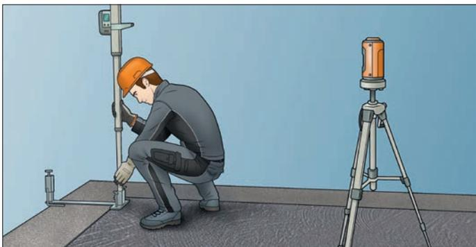
Ermittlung des höchsten Punktes der Betonplatte zur Festlegung der Höhe der Ausgleichs- bzw. Kimmschicht mit Baulaser. Daran orientierend Einrichtung des Justierboys zum Abziehen der Mörtelausgleichsschicht.
