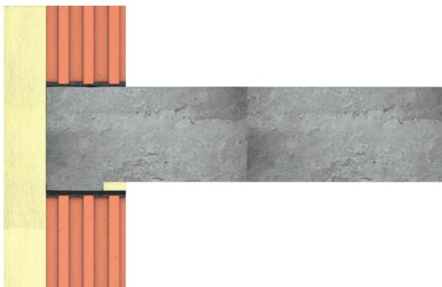
Deckenaufleger auf Mauerwerk mit WDVS
