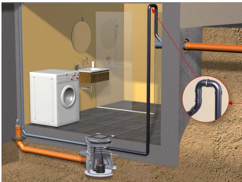
Die ACO Kleinhebeanlage Sinkamat-K zur Unterflurinstallation hat mehrere Anschlussmöglichkeiten und kann optional mit einem höhenverstellbaren Abdichtungsflansch für WU-Beton ausgerüstet werden.
