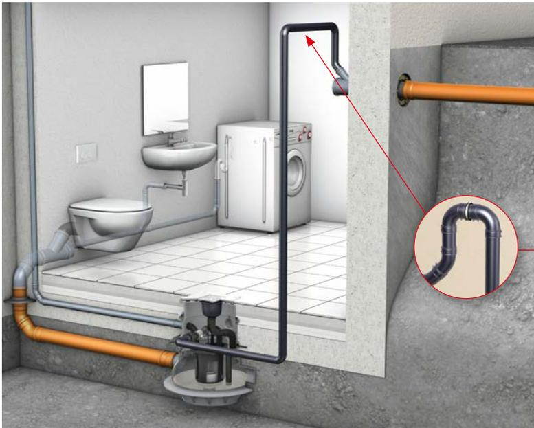
Die Abwasserhebeanlage Multi-UF für fäkalienhaltiges Abwasser ist speziell für den Anwendungsfall in Einfamilienhäusern entwickelt. Es bestehen drei Zulaufmöglichkeiten für einen optimalen Anschluss. Der höhenverstellbare Flansch zur Abdichtung im WU-Beton ist als Zubehör erhältlich.
