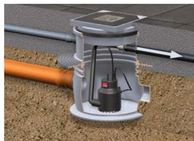
Mono-Hebeanlage für Grauwasser
