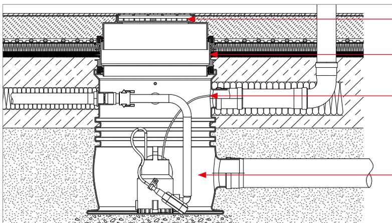
Teleskopisch verstellbares Aufsatzstück mit Wendeplatte K3
