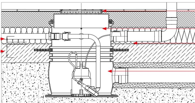
Teleskopisch verstellbares Aufsatzstück mit Wendeplatte K3
